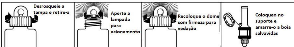
Instale o suporte e encaixe o Facho Homes RS QD2 com a lâmpada para baixo em posição invertida, amarre o cabo de 3mm a boia salva-vidas e em caso de emergência lance ambos ao mar.
